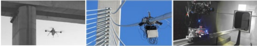
〈橋梁下部点検用ドローン〉 〈ケーブル点検ロボット〉 〈橋梁鋼ボックス点検ロボット〉
